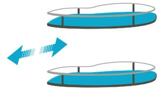
Leichtgängiges und geräuschloses Öffnen und Schließen durch selbsttätige, gedämpfte Auszüge.
